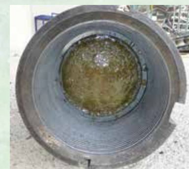
Endbefestigung der Tragseile für den Seilzug: Die einzelnen Litzen der Tragseile werden U-förmig gebogen (links), anschließend (Mitte) im Vergusskopf versenkt und mit einer Kunstharzmasse versiegelt (rechts). Der mit einem Gewinde versehene Vergusskopf kann nun verschraubt werden.
