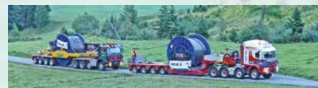
Tragseiltransport für die Piz Val Grondabahn: Das Seil wurde für den Transport auf zwei Trommeln aufgespult. Der hintere Sattelschlepper ist mit einer Schubstange mit dem vorderen verbunden.
