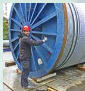
Markus Siegele beim über 90 Tonnen schweren Zugseil der Pardatschgratbahn.
